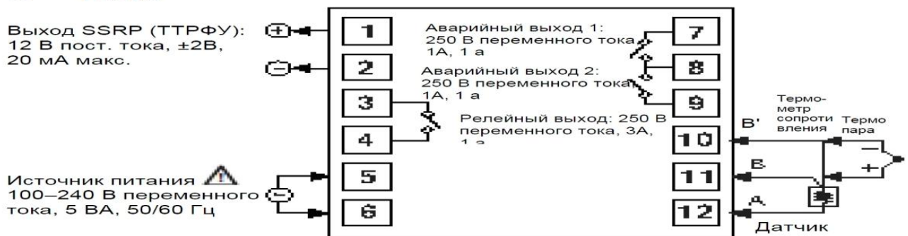
Рис. 9. Электрическая схема температурного контроллера.
